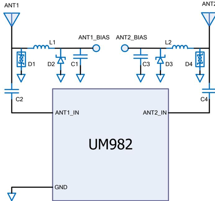
图 3-2 UM982 外部天线馈电参考电路
