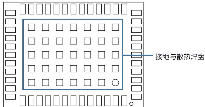
图 3-3 UM982 接地与散热焊盘（底视图）
