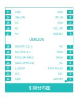
UM620N 模块是和芯星通针对车载导航应用推出的 GNSS 双频导航车规级模块。模 块基于完全自主知识产权的多系统、双频点、高性能 SoC 芯片 - UC6580A 设计,支 持多系统双频联合定位或单系统独立定位,特别在多径等复杂场景下仍可保障良好的 定位精度。
