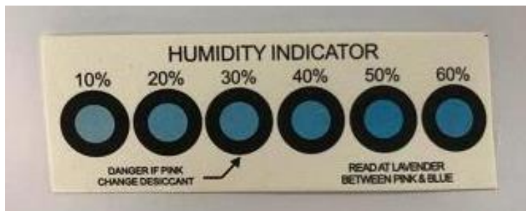
图 6-2 湿度卡的 30%标识圈显示为蓝色
