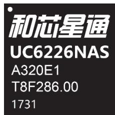
图 11-1 QFN 产品外观示例
